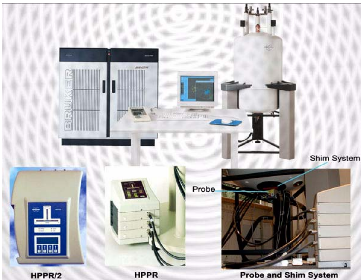
Figure 4.2. Foto von Magnet, Shimssystem, Probenkopf und HPPR
