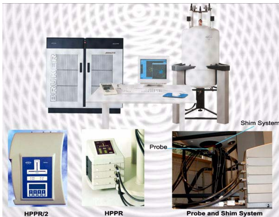
Figure 4.2. Photographie de l'aimant, du système de shims, de la sonde de mesure et du HPPR
