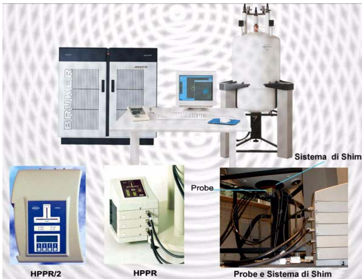
Figura 4.2. Foto del Magnete, del Sistema di Shim, del Probe e dell'HPPR
