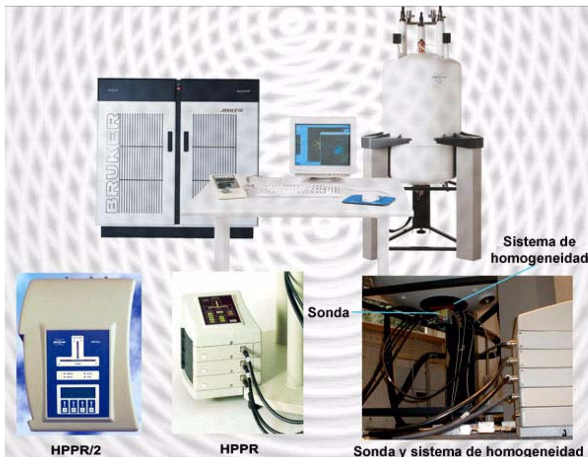
Figura 4.2. Imagen del imán, sistema de homogeneización, sonda y amplificador HPPR
