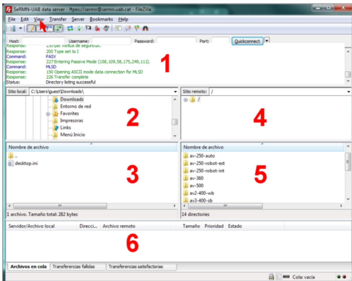
La figura anterior mostra la pantalla del FileZilla amb la configuració gràfica per defecte,
