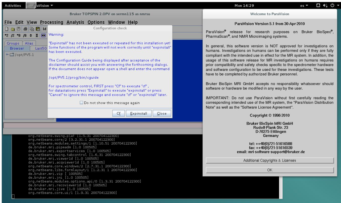
Com es pot veure a la captura de pantalla, es mostra la finestra de configuració de l'espectròmetre *Configuration check* i caldrà executar les comandes Cf i Expinstall per configurar l'espectròmetre (en aquest cas, una datastation).
